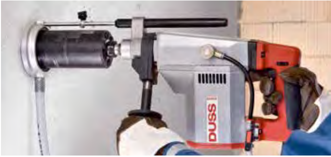
Dozen boren nat in beton met waterafzuiging
