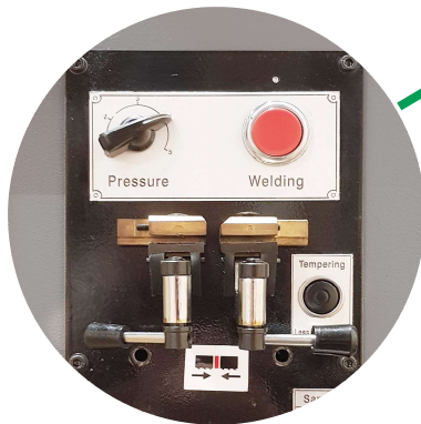
Knip-, las- en slijpinrichting t.b.v. lintzaagblad
